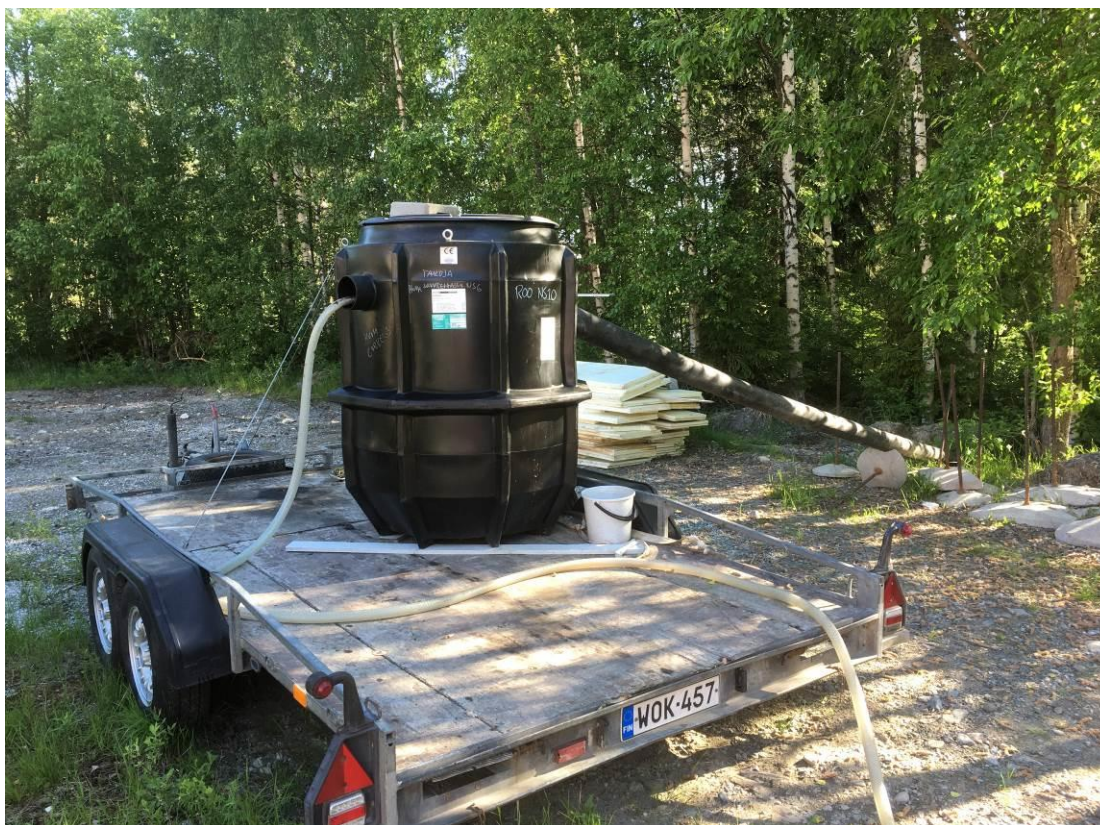
Kohteessa käytössä ollut öljynerotin, kuva 3.7.2017
